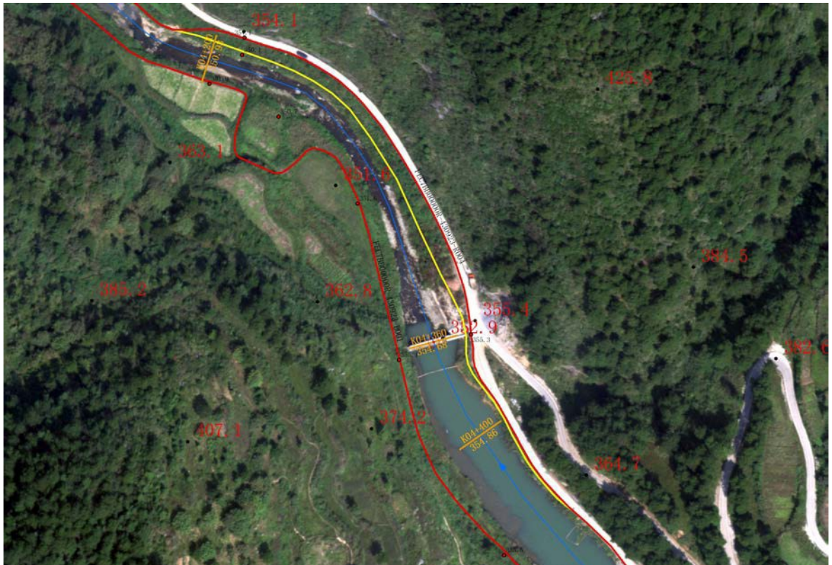
十年一遇设计洪水位线结合道路边线划定
